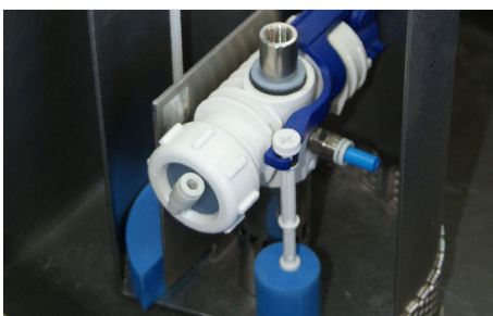
Der Bewässerungsautomat im [zur Darstellung aufgetrennten] Schacht .
