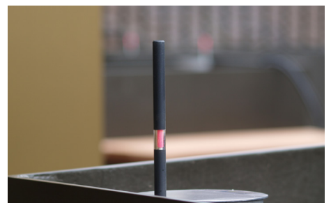
Ist der Wasserstand im Gefäss zu tief, zeigt dies die Wasserstandsanzeige mit Rot an.
