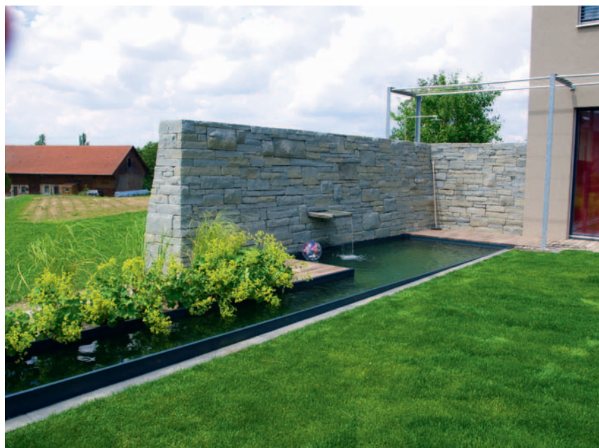
Wasserbecken (9 x 2.1 m) aus Glasfaser-Composite als Abgrenzung eines Privatgrundstücks
