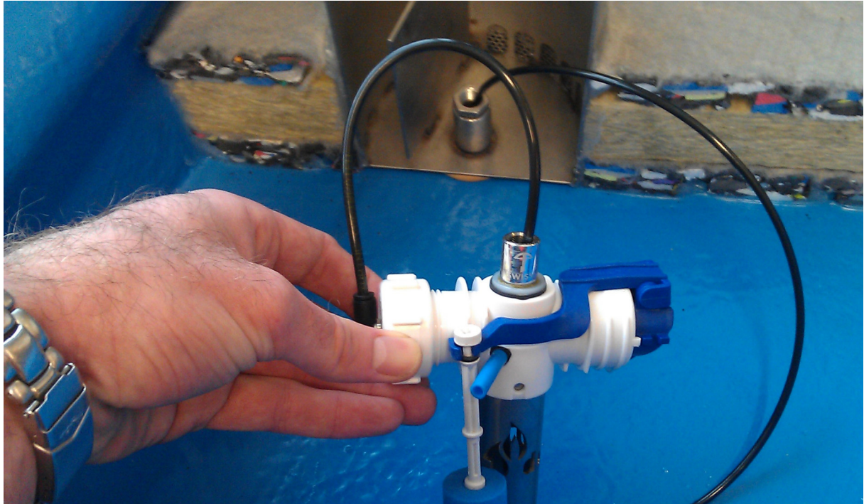
Bild 8: Der Bewässerungsautomat wird über den Überlaufstutzen (im Hintergrund) gestülpt
