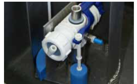
Querschnitt eines Schachtes, bestückt mit einem duroplant-Bewässerungsautomaten.
