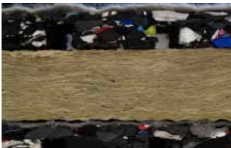
Querschnitt des duroplant-Vegetationsträgers.
