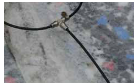
Bei mehreren Gefäßen können die Zuleitungen mit sogenannten T-Stücke miteinander verbunden werden.
