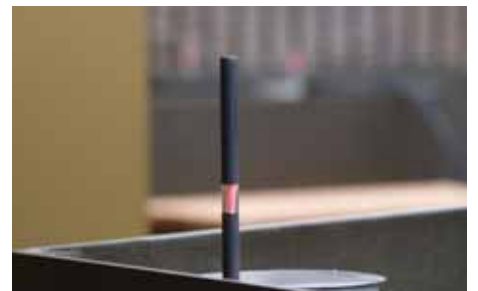
Ist der Wasserstand im Gefäß zu tief, zeigt dies die Wasserstandsanzeige mit Rot an.
